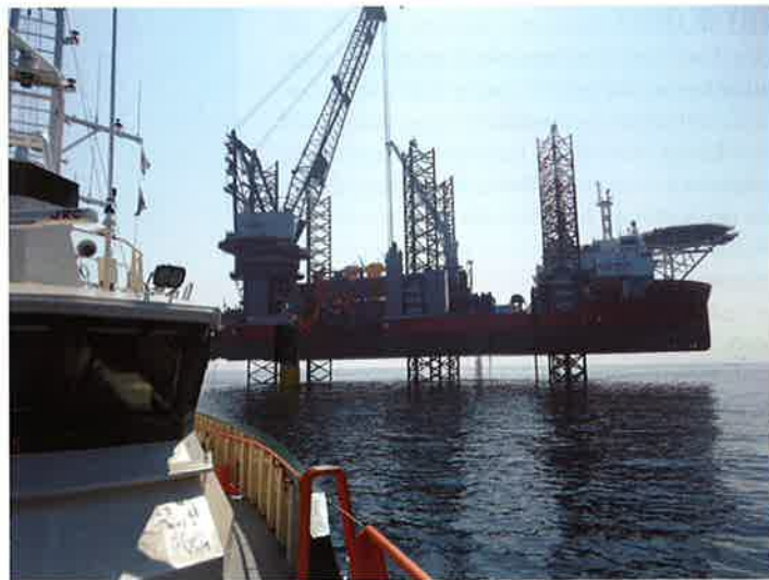
De 'Geo Focus' voert werkzaamheden uit nabij de Pacific Osprey welke verantwoordelijk is voor het plaatsen van de monopiles.
